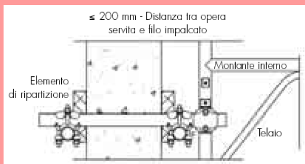
Esempio di ancoraggio "a cravatta"
