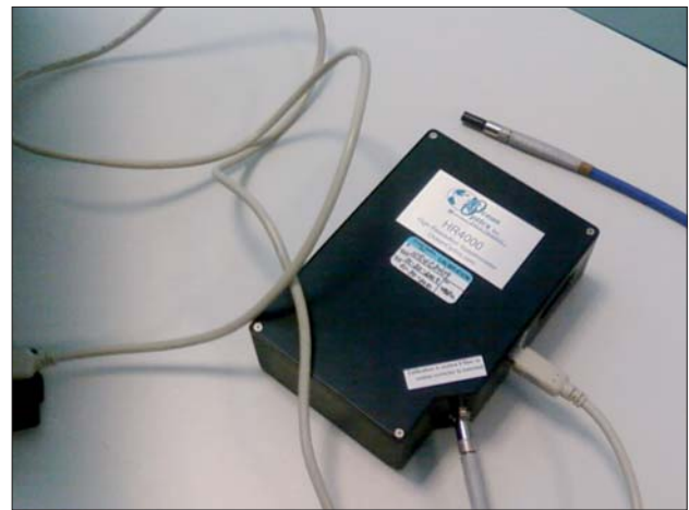
Figura 2. Spettroradiometro Ocean Optics HR-4000, utilizzato per le misure spettrali nel campo dell'UV-Visibile
