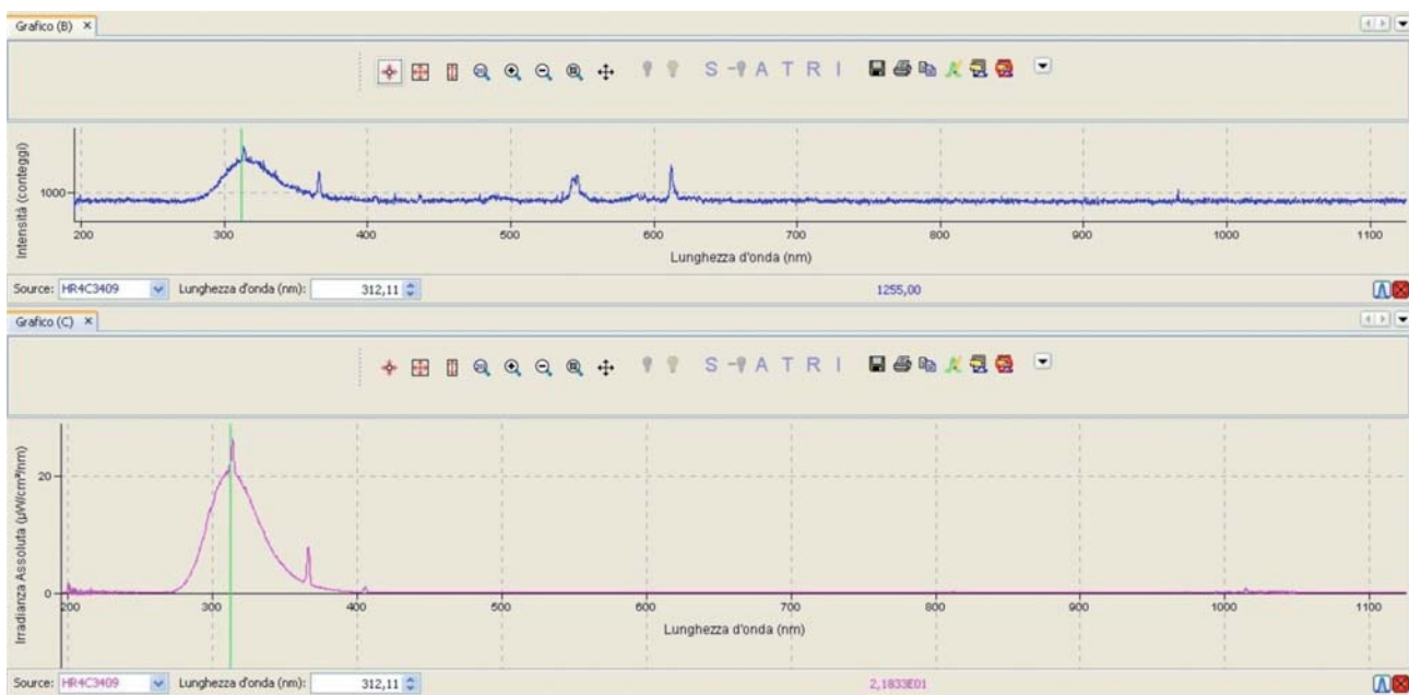
Figura 3. Confronto fra lo spettro misurato e quello ottenuto dopo la sottrazione del fondo e l'applicazione della calibrazione di riferimento, sotto i 210 nm è visibile una piccola regione di irradianza "spuria" generata dal software a causa delle approssimazioni
