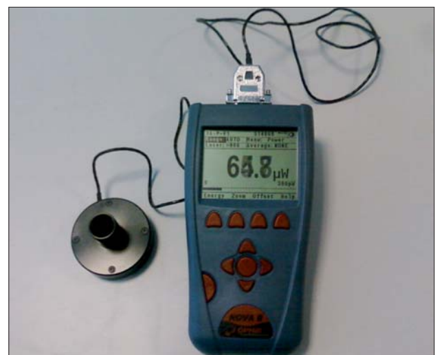
Figura 7. Radiometro OPHIR Nova II, dotato di rivelatore a termopila 3 A-P-DIF-V
